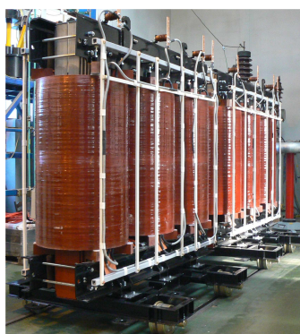
Transformatory 8000kVA o przekładni 20/6kV
