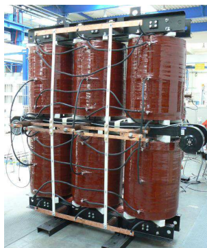
Трансформатор 24-импульсный для питания преобразователя частоты 50/60Гц мощностью 1600кВА напряжением сети 15кВ
