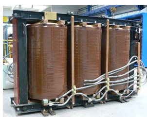
Трансформатор 2600кВА для взрывозащищенной подстанции, применяемой в угольных шахтах напряжением 6/3кВ
